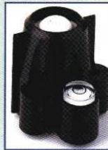
**UV senzor** monitoruje ultrafialové záření ve spektru 290 až 360 nm (UVB + UVA). Konzola zobrazuje jak UV Index, tak i dávku UV záření, po které začíná vaš typ pokožky rudnout nebo pigmentovat. Charakteristika senzoru kopíruje díky speciálním filtrům citlivost lidské pokožky na UV záření pronikající atmosférou (Erythema Action Spectrum). Kromě spálené pokožky pfináší nadměrné vystavování UV záření mnoho dalších zdravotních problémů jako stárnutí kůže, zvýšení rizika rakoviny, šedý zákal apod.
