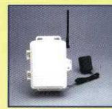
**Opakovač signálu** významně prodlužuje dosah bezdrátového systému. Ideální, pokud chcete signál z jedné stanice pokrýt větší území. Až osm opakovačů v řadě za sebe prodluží dosah na vzdálenost kolem 1,6 kilometru. K dispozici jsou dvě verze lišící se napájením – AC adaptér nebo fotovoltaický článek s akumulátorem.
