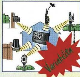
VantagePro® nabízí vysokou variabilitu bezdrátového systému. Ke konzole (či více konzolám) lze připojit až osm různých vysílačů (viz. obr.).
