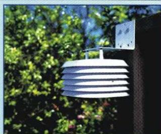
**Vysílač se senzory pro měření teploty a relativní vlhkosti vzduchu** se dodává buďto s pasivním radiačním šitem, nebo aktivním aspiračním šitem FARC. Typ s pasivním radiačním šitem je napájen z běžně dostupné lithiové baterie typu 123A umožňující roční provoz, zatímco fotovoltaický článek u aspirační verze dodává energii vysílači i ventilátoru a zároveň dobíjí akumulátory umožňující provoz i v obdobích bez slunečního svitu.
